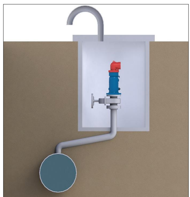
Dos válvulas de aire en una válvula de aislamiento compartida. Las salidas de las válvulas de aire están orientadas hacia afuera, y las válvulas de aislamiento en un ángulo de 45° con respecto a las salidas de las válvulas de aire
